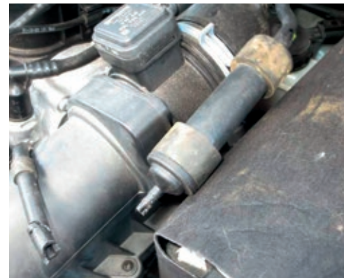
Beschädigung durch Nagetiere
