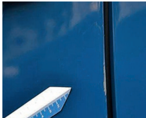
Leichter Lacksschaden an Türkante
