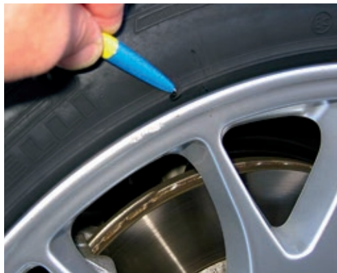
Leichte Materialabtragung an der Scheuerleiste
