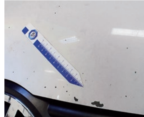
Mehr als fünf Steinschläge pro 10 \times 10 cm
